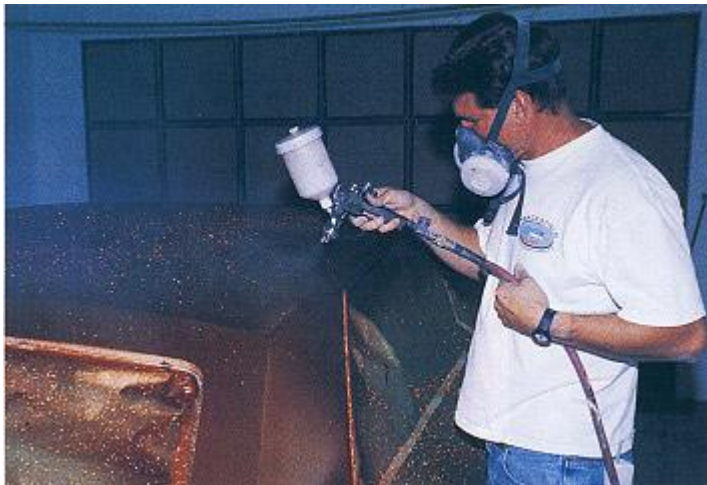
Ди-Боб демонстрирует процесс распыления металлических блесков.
